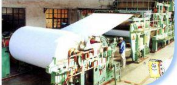
Опилки сварили, чтобы получить массу, похожую на жидкое тесто. Древесное тесто раскатывают в длинные широкие полосы. Сырая бумажная лента проходит через целый ряд валков. Одни валки отжимают воду, другие высушивают ленту, третьи полируют.
